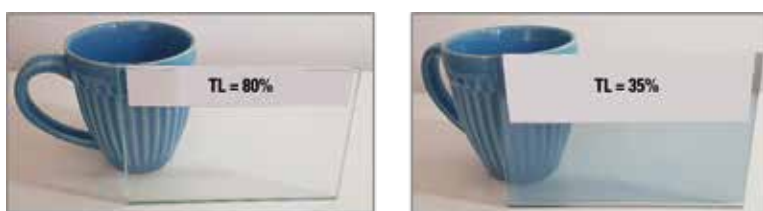
Figura 6: Comparativo entre um vidro incolor comum (esq.) com TL 0,80 e um vidro de controle solar (dir.) com TL 0,35.
