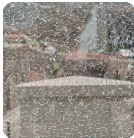
Figura 02: Padrão de quebra do Vidro Temperado em pequenos fragmentos.
