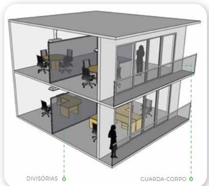
Figura 09: Vidros instalados em divisórias e guarda-corpos
